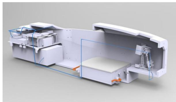
整车线束通过 CATIA 和 EPLAN 线束建模设计，模拟线束的走向与长度。布置上，集中一侧、立体分层的设计思路使线束繁杂问题得到有效解决，极大简
